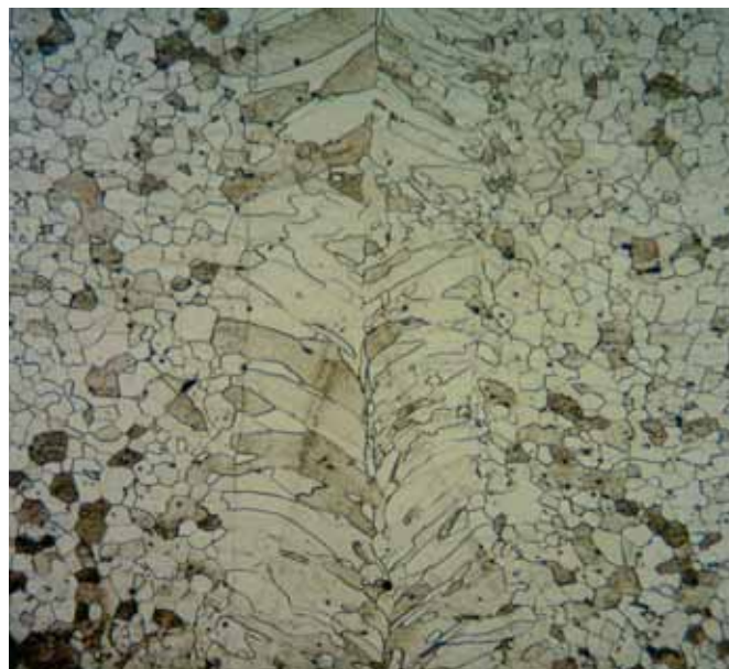
Texte de l'ill. 2: Photo micro, soudure au laser étroite 1.4521 en coupe transversale
