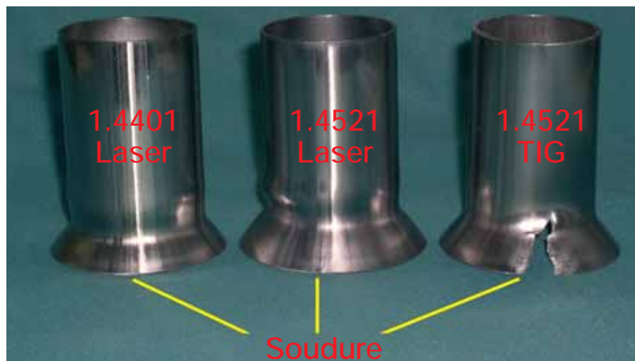
Texte Ill. 6: Les essais d'évasement par comparaison, soudure laser sur 1.4401 et 1.4521 idéale, soudure TIG 1.4521 avec fissure par grossissement du grain.
